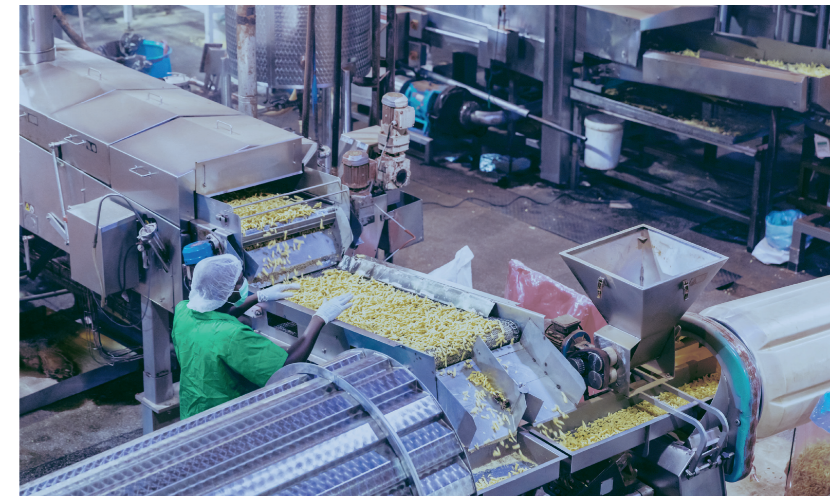
FM zugelassener und EN 14972 konformer Niederdruckwassernebelerschutz für Industriefritteusen.
